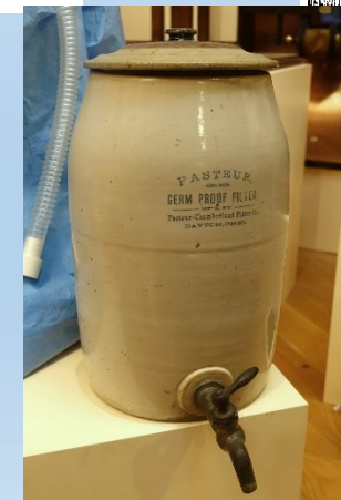
Le filtre de Chamberland Stérilisation par la rétention des microbes (1884)
